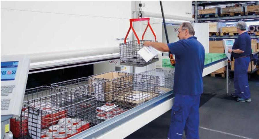
◀ (v.li.n.re.) Um die zunehmenden Produktionssteigerungen bei den Herforder Elektromotoren-Werken weiterhin beherrschen zu können, wurden sechs Hänel-Vertikallifte vom Typ Lean-Lift direkt vor den Montagelinien installiert (Fotos: Hänel)
